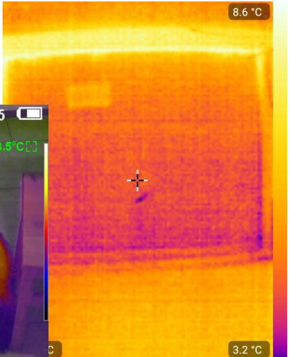
La photo de gauche avec le chat, prise avec la caméra que nous avons acquise, est un bon exemple de son principe de fonctionnement : nous y voyons notamment la température au centre de l'image, ainsi que la mesure la plus élevée et la plus basse. Les couleurs représentent la répartition des températures. L'image de droite, prise avec un autre modèle de caméra, illustre une application possible : mesurer les pertes de chaleur d'un bâtiment (ici une porte de garage).
